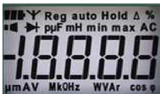
Рисунок 10.3 - Рабочее поле индикатора мультиметра
