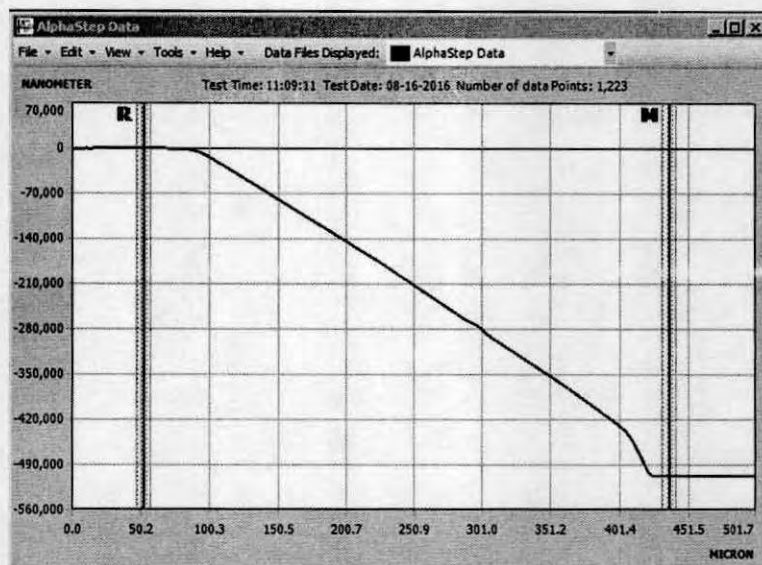
Рисунок 22 – Измерение высоты меры SHS-1,8QC
