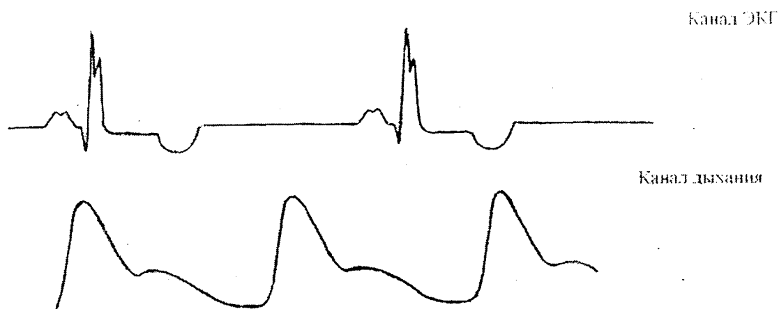
Рисунок 10 – Форма сигналов в каналах ЭКГ и дыхания. (синхронизация сигналов по каналам отсутствует)
