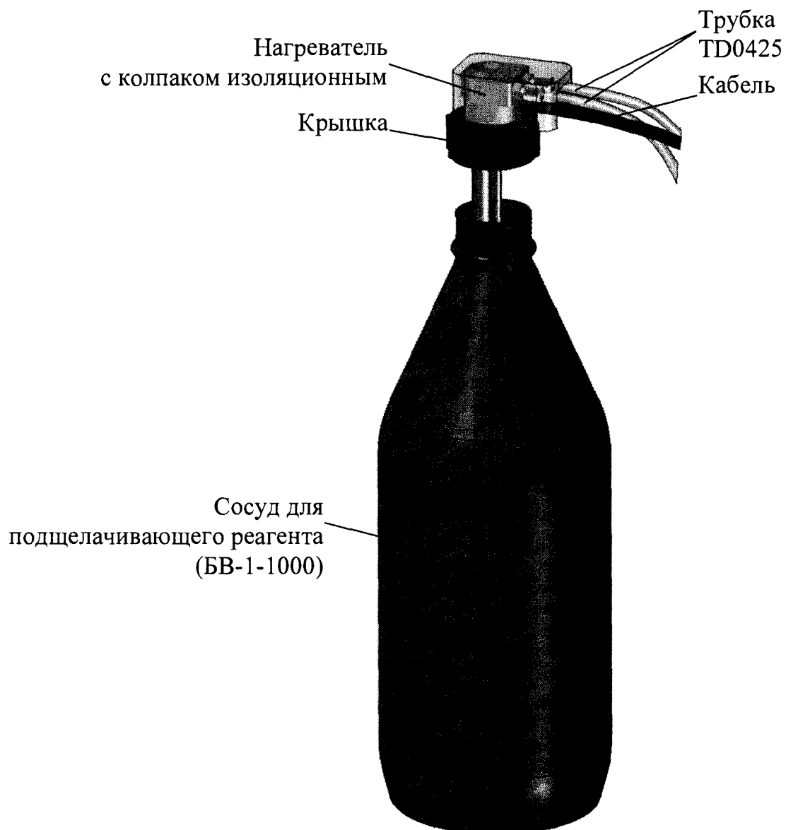
Рисунок 2.14 – Заливка подщелачивающего реагента в сосуд гидропанели ГП-1002Т
