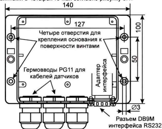
Рисунок 5.1 – Схема крепления вычислителя
