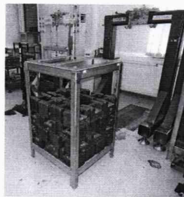
Рисунок 2 – Технологическая корзина для нагружения датчиков сдвига или изгиба
