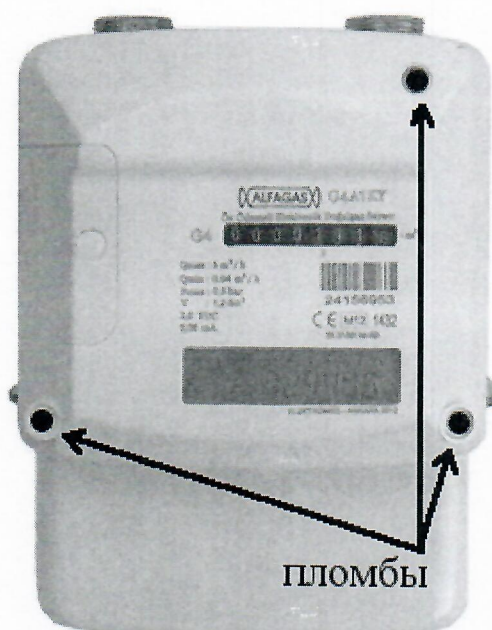
Р и с у н о к 1 – Схема пломбировки от несанкционированного доступа, обозначение места нанесения знака поверки
