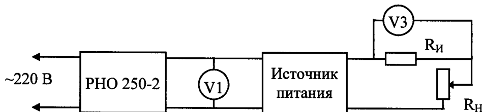
Рис. 4б. Структурная схема определения основной погрешности измерения выходного тока свыше 3 А при помощи вольтметра и измерительного резистора.
