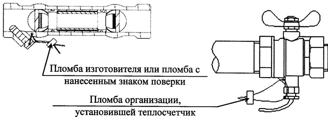
а) схема пломбировки термопреобразователя сопротивления на датчике расхода
