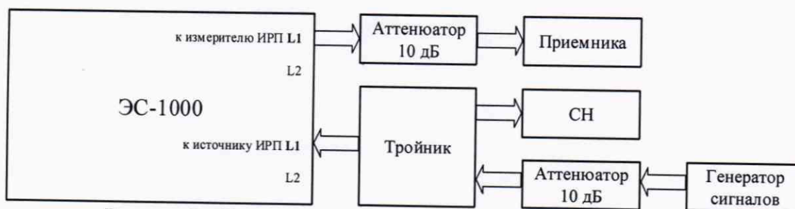
Рисунок 2 - Схема измерений выходного уровня эквивалента сети
