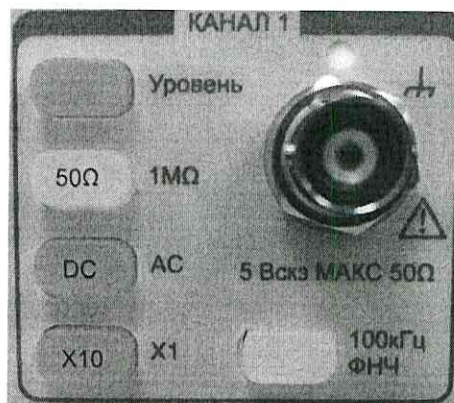
Рисунок А.4 – Параметры входного измерительного канала частотомера электронно-счетного серии ЧЗ-85/6 (п. 8.4.4)
