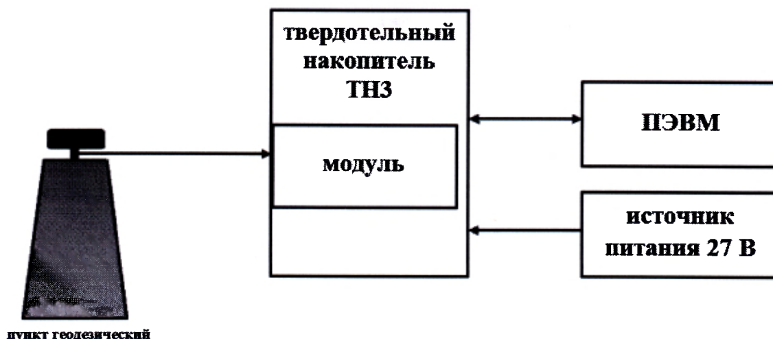
Рисунок 2 – Схема для проведения измерений при определении погрешности определения координат местоположения на пункте геодезическом
