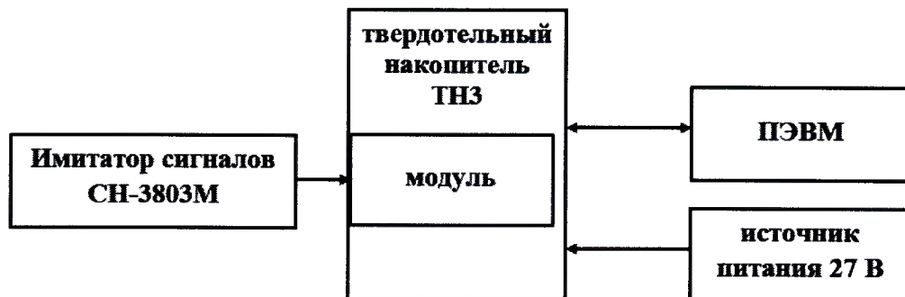
Рисунок 1 Схема для проведения измерений при проверке работоспособности
