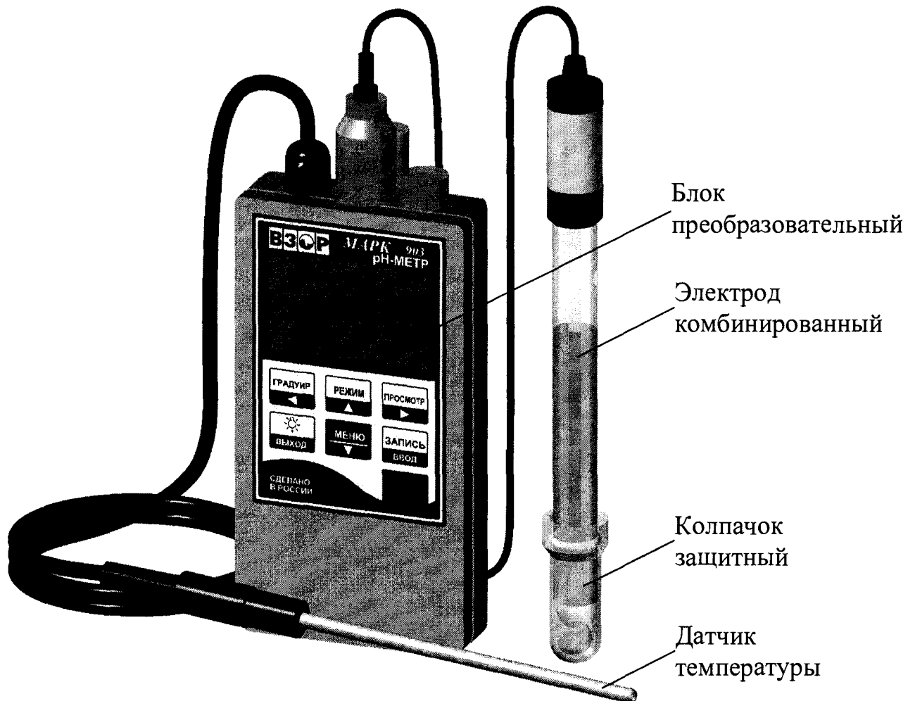
Рисунок 1.1 – pH-метр МАРК-903 (вид спереди)
