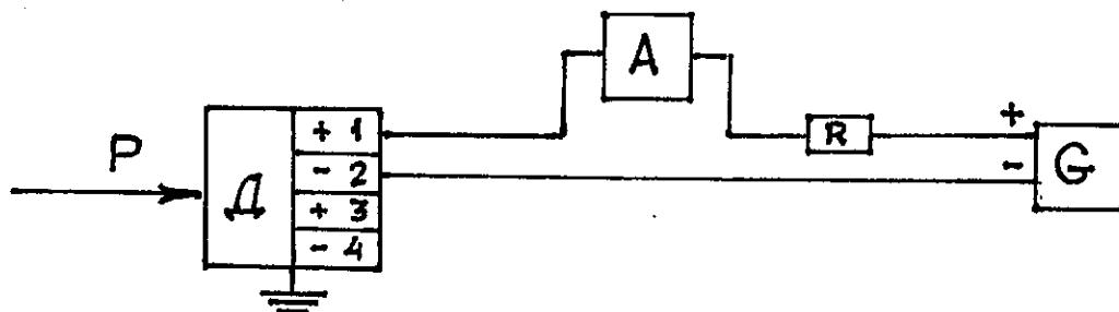
P – входная измеряемая величина (примеры подключения к датчику эталонных СИ входной величины и эталонных задатчиков давления приведены на схемах 8 и 9 соответственно);
