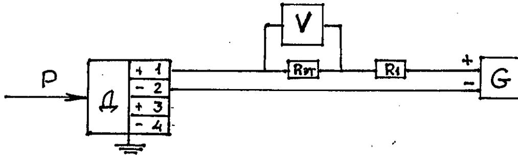
V – цифровой вольтметр или компаратор напряжения постоянного тока, указанные, например, в табл.1;
