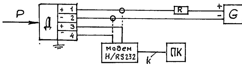
Модем – устройство связи и преобразования сигналов HART/RS232;
