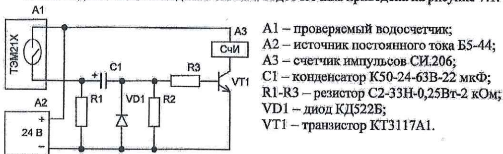
Рисунок 7.1 Схема подключения выходного сигнала
