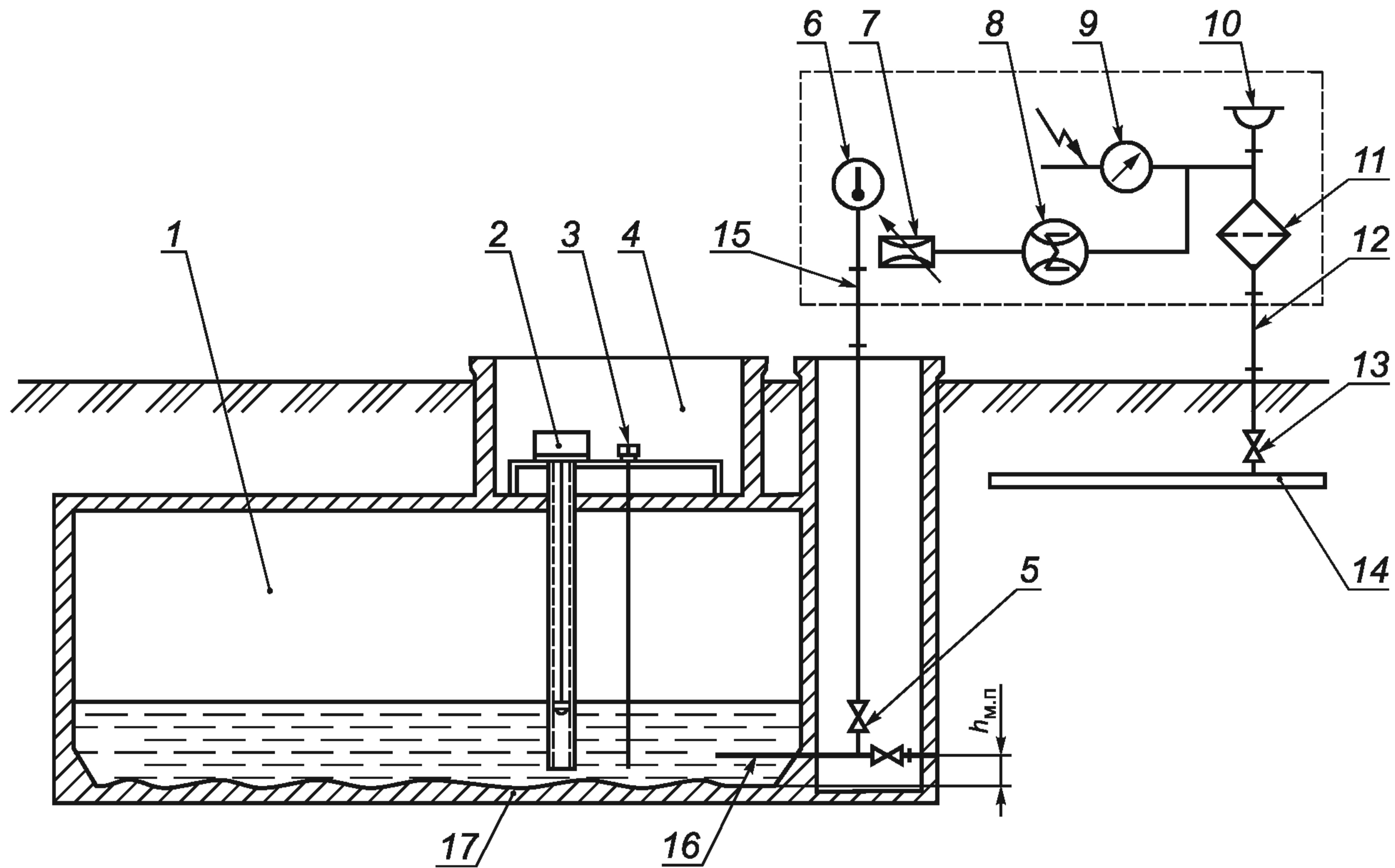
1 — резервуар; 2 — уровнемер; 3, 6 — измерители температуры; 4 — колодец; 5, 13 — задвижки; 7 — дроссель; 8 — счетчик жидкости; 9 — измеритель давления (манометр); 10 — воздухоотделитель (вантуз); 11 — фильтр; 12, 15 — рукава; 14 — технологический трубопровод; 16 — приемно-раздаточный патрубок; 17 — днище резервуара;  $h_{м.п}$  — высота «мертвой» полости
