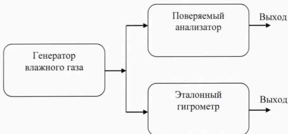
Рис. 1. Схема подключения эталонного гигрометра и поверяемого анализатора к генератору влажного газа. Стрелками указано направление потока газа.
