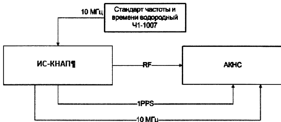
Рисунок 8 - Схема измерений инструментальных погрешностей ИС-КНАП по фазе дальномерного кода, по фазе несущей частоты
