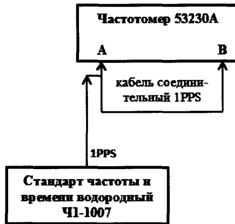
Рисунок 2 – Схема измерений временной задержки ВЧ-кабеля «1PPS»
