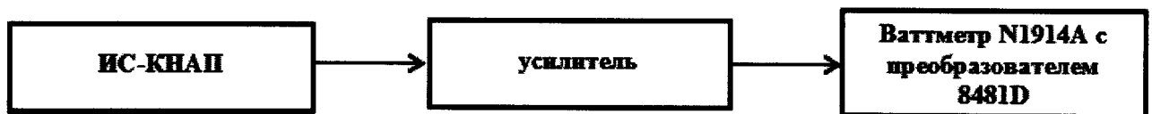
Рисунок 7 – Схема измерений выходной мощности имитатора сигналов
