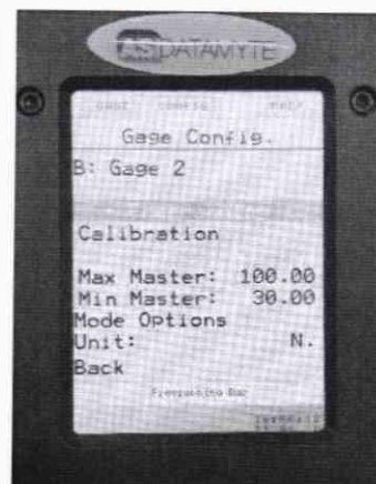
Рис. 3 – Перевод в режим измерения «Freerunning» шаг № 2.
