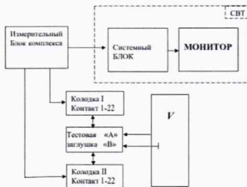
Рисунок 3 – Схема измерений напряжения постоянного тока и переменного тока частотой 50 Гц
