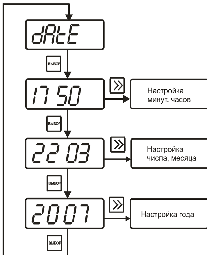
Рисунок 16 Меню установки часов реального времени приборов ИВТМ-7М1, ИВТМ-7М2, ИВТМ-7М3, ИВТМ-7М5, ИВТМ-7М5-3
