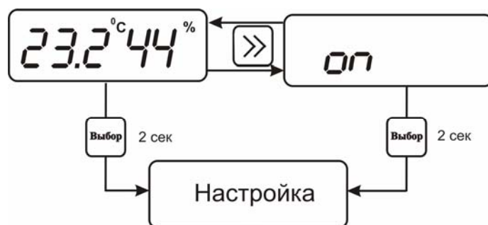
Рисунок 8 Режим “РАБОТА” прибора ИВТМ-7М4
