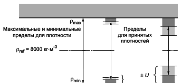
Рисунок В.3 - Допуски для плотности и пределы при поверке в зависимости от неопределенности измерений
