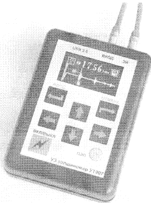
Рис.1.1. Ультразвуковой толщиномер УТ907.
