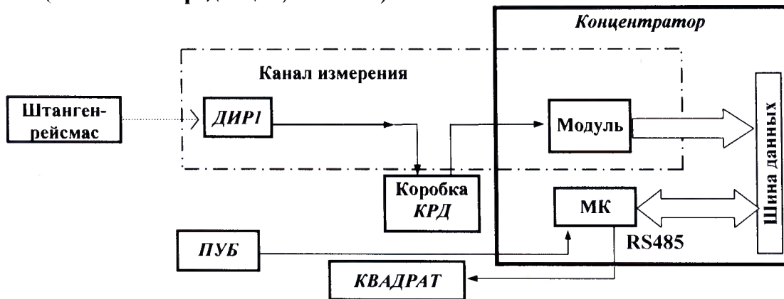
Рисунок 5 – Структурная схема соединений канала измерения «Изменение расхода бурового раствора на выходе»
