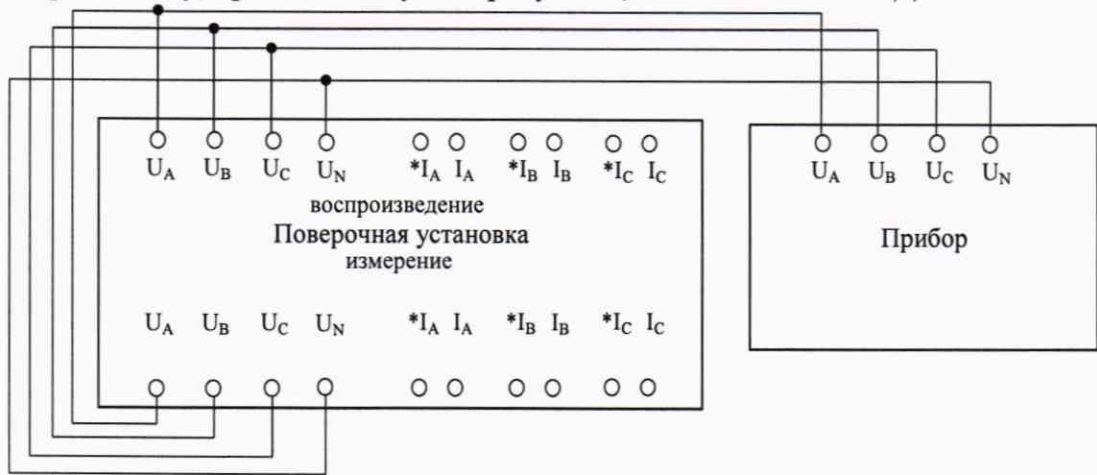
Рисунок 1 – Схема подключения при измерении напряжения переменного тока
