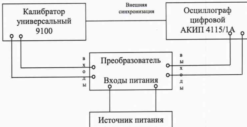
Рисунок 1 – Структурная схема проверки допускаемой основной приведенной погрешности преобразования
