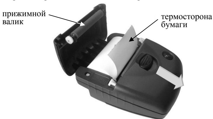
Рисунок 16 – Установка термобумаги в принтер
