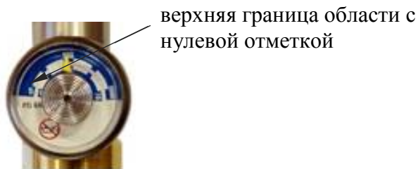
Рисунок 19 – Манометр на редукторе баллона
