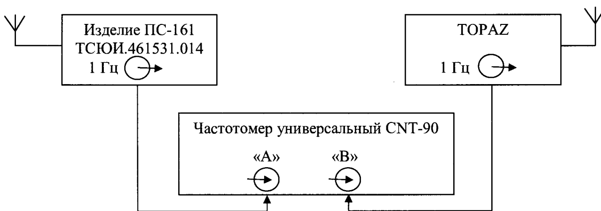
Рисунок 1 – Схема для определения смещений формируемой ШВ относительно ШВ UTC(SU) в режиме синхронизации по сигналам ГНСС ГЛОНАСС/GPS
