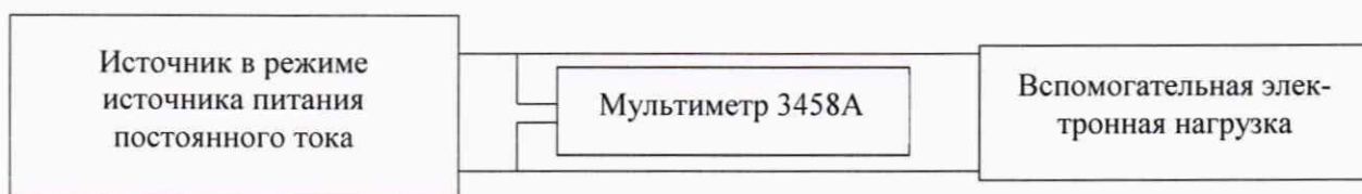
Рисунок 1 – Структурная схема определения приведенной (к номинальному значению) основной погрешности воспроизведений напряжения постоянного тока
