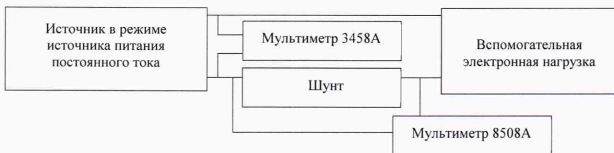
Рисунок 3 – Структурная схема определения приведенной (к номинальному значению) погрешности воспроизведений электрической мощности
