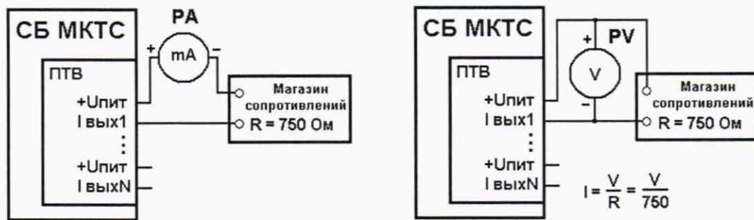
Измерение тока с помощью миллиамперметра
