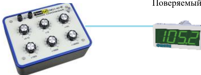
Рисунок 1 – Схема определения основной приведенной (к диапазону измерений) погрешности измерений при измерении входных сигналов от термопреобразователей сопротивления
