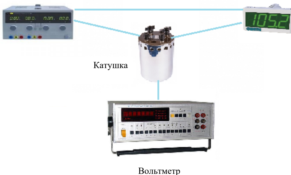
Рисунок 4 – Схема определения основной приведенной (к диапазону измерений) погрешности измерений при измерении входных сигналов от датчиков с унифицированным сигналом постоянного тока (при определении погрешности методом падения напряжения на сопротивлении)
