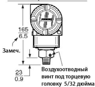
IAP10/IGP10 с воздухоотводным винтом в технологическом соединении Опция - V1
