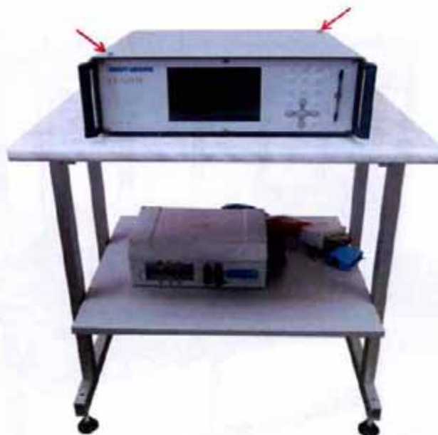
Рисунок 3 - Общий вид стойки эталонного счетчика установок исполнений ЦУ6800М-Р, ЦУ6800МИ, ЦУ6800МИ-Р, ЦУ6800М-Т, ЦУ6800МИ-Т и места пломбирования эталонного многофункционального ваттметра-счетчика СЕ603М на верхней панели
