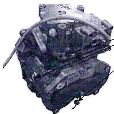
Рисунок Б.4 – Схема пломбировки измерителя объёма с генератором импульсов, производства фирмы «Tokheim UK Ltd.»
