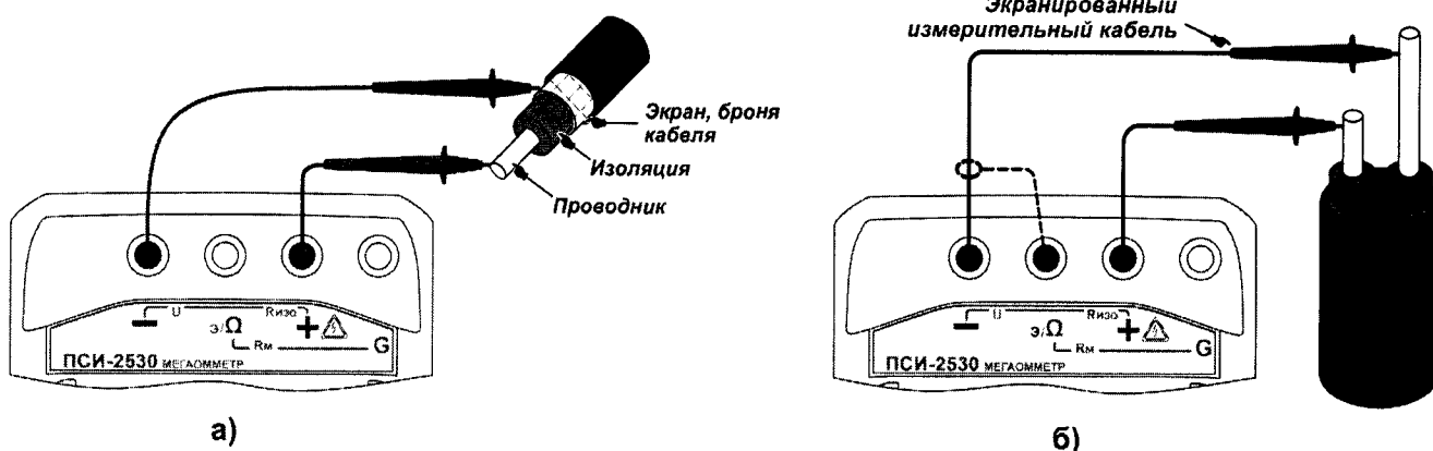
Рисунок 2.5 - Измерение сопротивления изоляции кабеля
