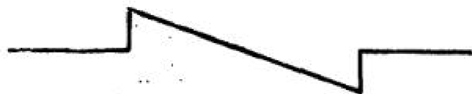
Рис. 15. Осциллограмма скомпенсированного импульса (Л2-42)
