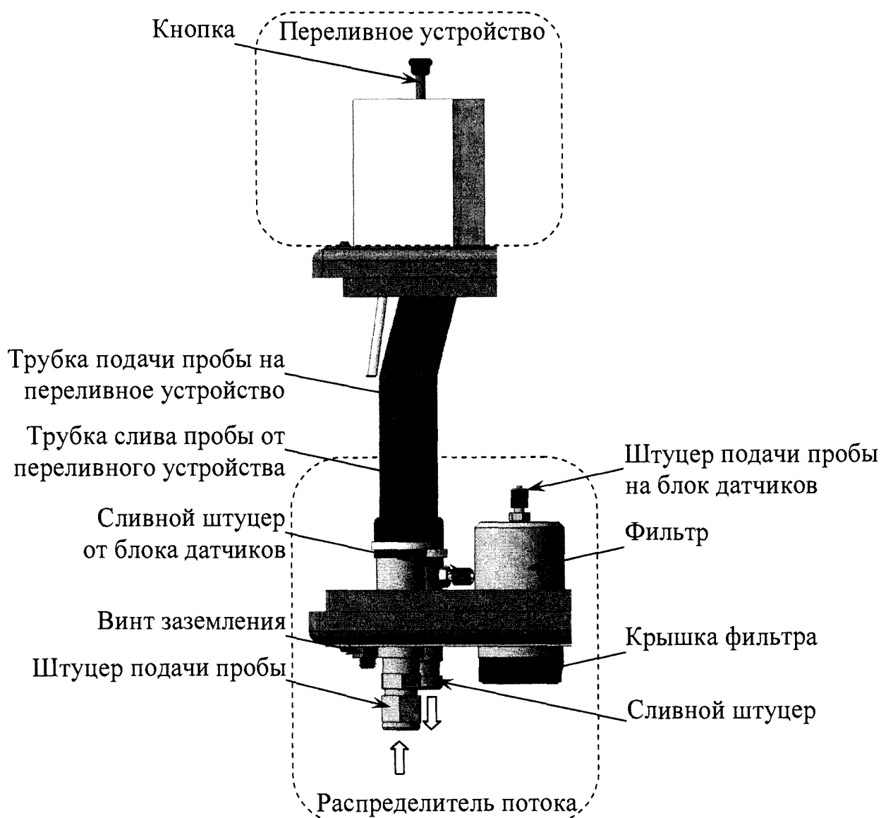
Рисунок 1.9 – Стабилизатор потока
