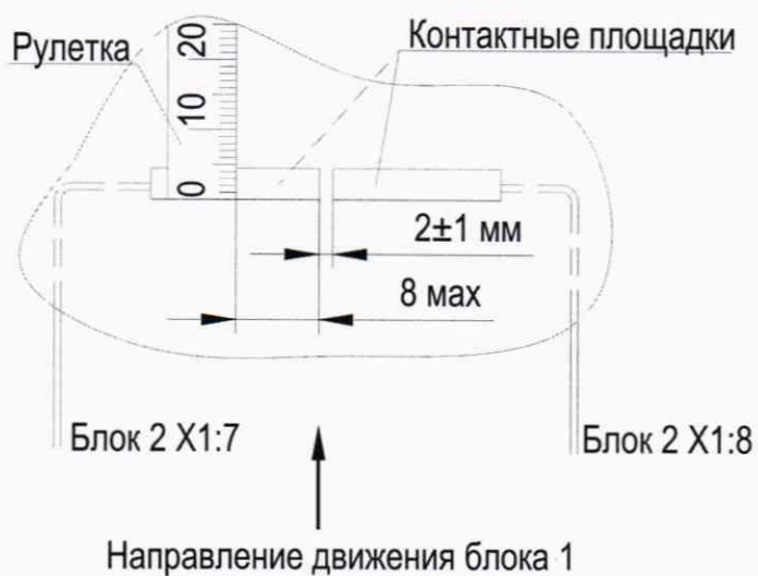
Рисунок Г3 – Расположение контактных площадок
