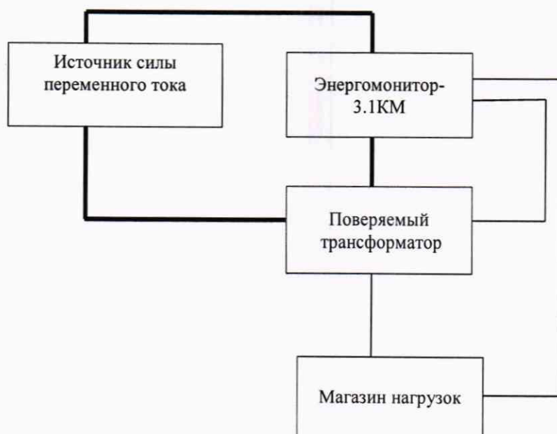
Рисунок 2 – Структурная схема для определения токовых и угловых погрешностей трансформатора при значениях первичного тока 0,2 % от номинального с использованием Энергомонитора 3.1КМ
