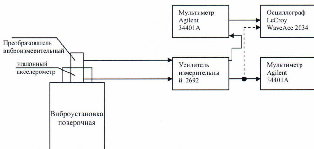
Рисунок 1 – Схема подключения преобразователя виброизмерительного при проведении поверки
