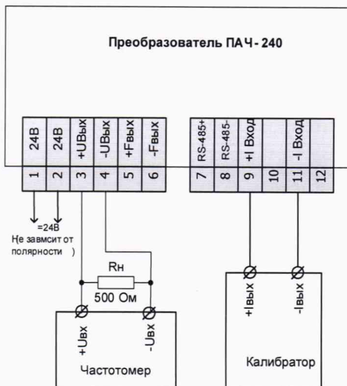
Рисунок А.2 – Схема подключения преобразователя и средств поверки при определении метрологических характеристик преобразователей по импульсному выходу
