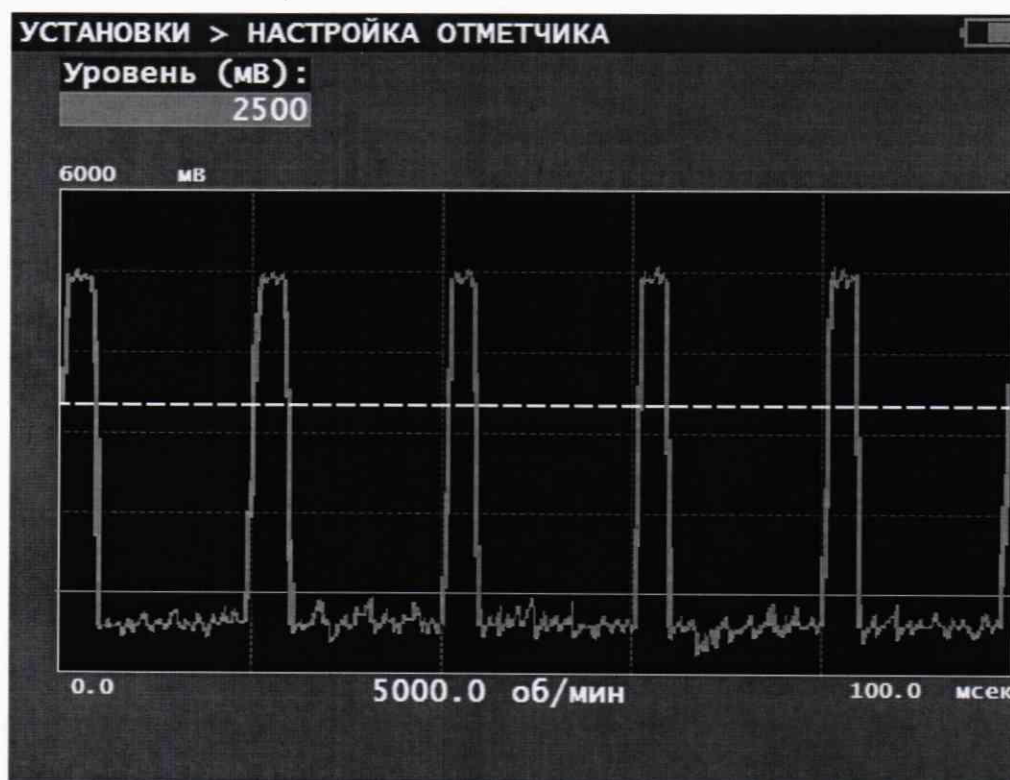
Рис. 4 Графическое изображение настройки уровня отметчика
