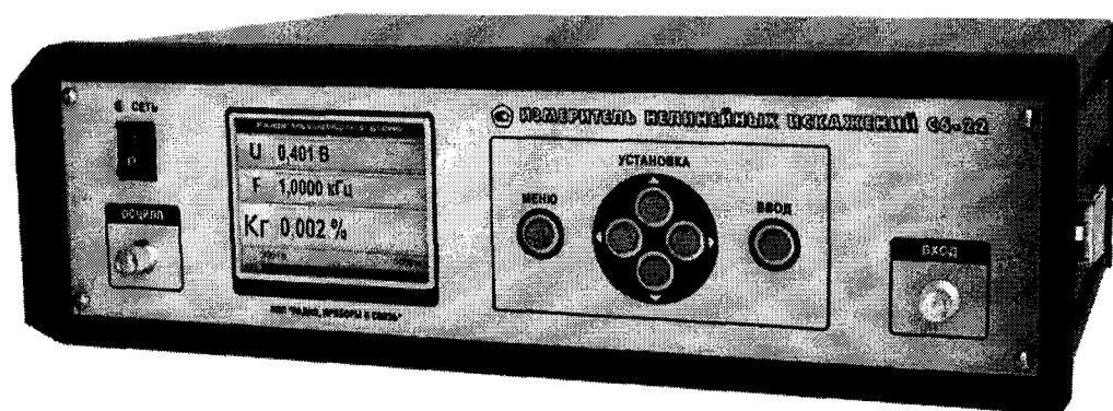
Рисунок 4.1 – Внешний вид измерителя нелинейных искажений С6-22
