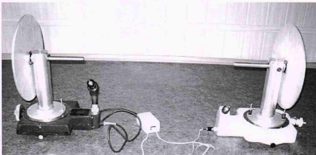
Рисунок 2 – Имитация передней оси автомобиля установками угломерными
