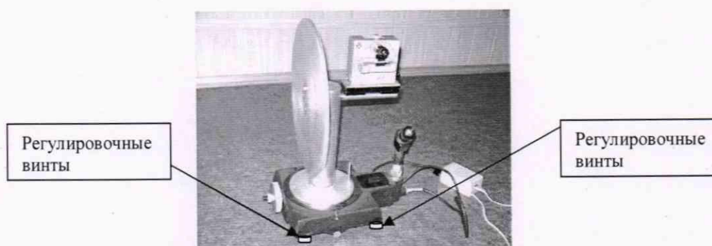
Рисунок 1 – Установка угломерная на основе столов поворотных СТ-9
