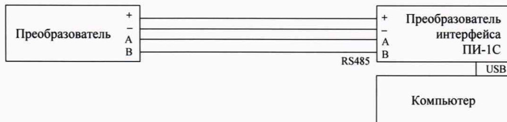
Рисунок 5 – Схема подключения преобразователей модификации -С (вместо преобразователя интерфейса ПИ-1С допускается использовать аналогичные преобразователи интерфейса RS232-RS485 или USB- RS485 при условии организации внешнего питания преобразователя 12В).
