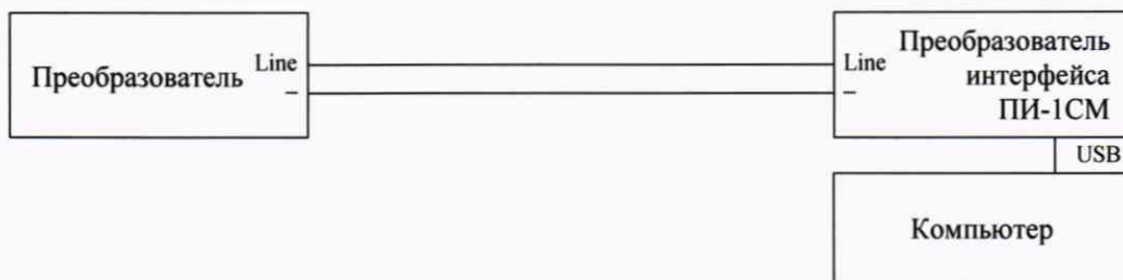
Рисунок 6 – Схема подключения преобразователей ДТР-3-СМ, ДТР-3Р-СМ и ДТР-4-СМ.
