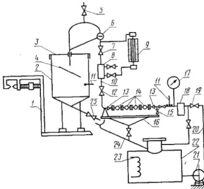
1—устройство для измерения массы; 2—тара; 3—крышка меры; 4—струегаситель; 5—воздухоотводящий кран; 6—смотровой глазок; 7—насадочный кран; 8—смотровое стекло; 9—расходомер; 10, 20—подводящий трубопровод; 11—термометр; 12—регулирующий кран; 13—устройство для подсоединения счетчиков; 14—счетчик; 15, 25—сливной кран; 16—стол-стенд; 17—манометр; 18—фильтр-воздухоотделитель; 19—пусковой кран; 21—насос; 22—резервуар; 23—нагреватель или охладитель; 24—сливной трубопровод
