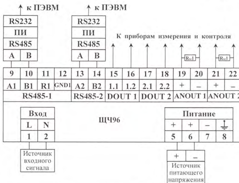
а) схема подключения ЩЧ96
