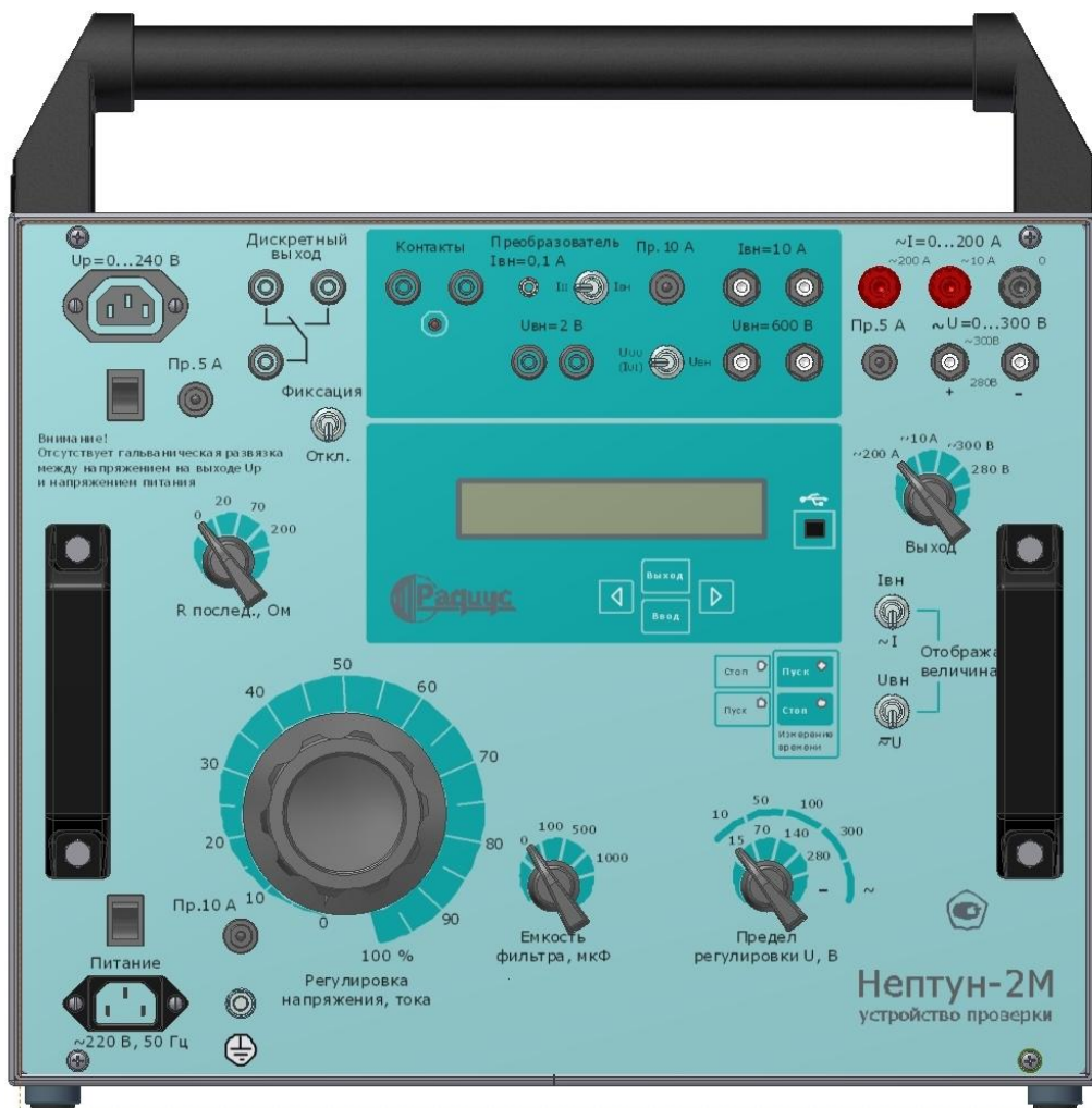
Рисунок 1 – Панель управления устройства «Нептун-2М»
