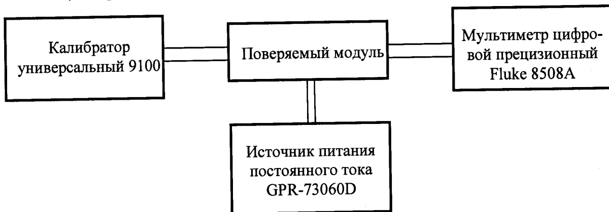
Рисунок 1 – Структурная схема опробования и определения основной относительной погрешности преобразований напряжения электрического тока
