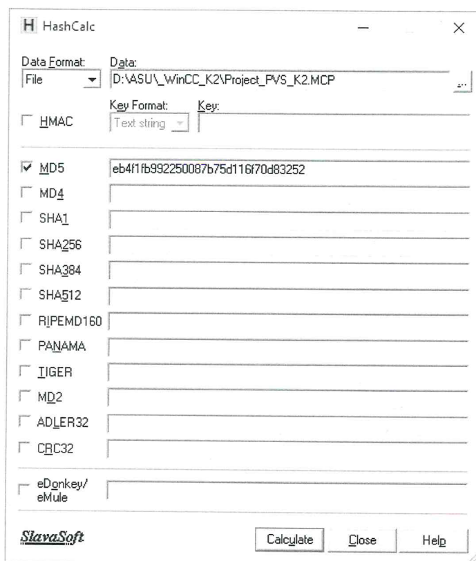
Рисунок 2 – расчет контрольной суммы MD5 файла конфигурации станции визуализации
